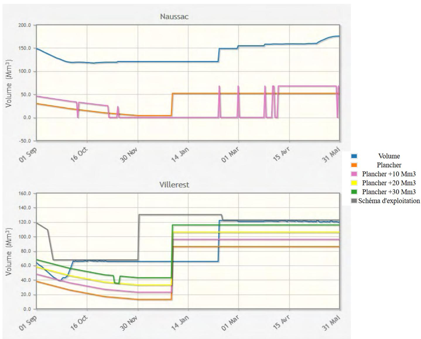
La courbe « schéma d'exploitation » correspond pour Villerest aux règles de gestion conditionnées par sa double fonction de soutien d'étiage et d'écrêtement de crue. Les courbes "plancher" sont des courbes "guide" pour le soutien d'étiage.
