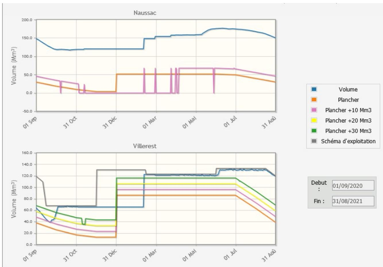
La courbe « schéma d'exploitation » correspond pour Villeret aux règles de gestion conditionnées par sa double fonction de soutien d'étiage et d'écrêtement de crue. Les courbes "plancher" sont des courbes "guide" pour le soutien d'étiage.
