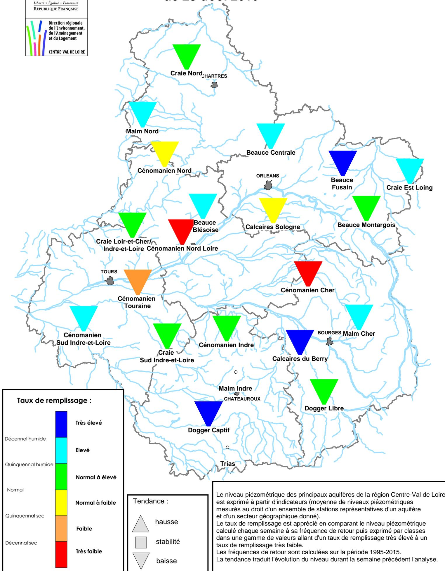
Le niveau piézométrique des principaux aquifères de la région Centre-Val de Loire est exprimé à partir d'indicateurs (moyenne de niveaux piézométriques mesurés au droit d'un ensemble de stations représentatives d'un aquifère et d'un secteur géographique donné).
