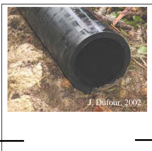
Fig.34-Tuyau en polyéthylène haute densité
