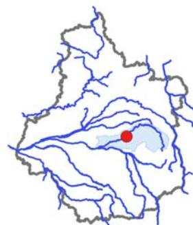
**Dans le bassin du Cher** (hors Sauldre), il est constaté un excédent d'écoulement de l'ordre de 200% de la normale sur l'axe Cher et ses affluents. Les débits de base révèlent, à l'amont, une situation exceptionnellement humide supérieure à la décennale jusqu'à Vierzon, puis très humide de l'ordre de la quinquennale humide vers l'aval jusqu'à la Loire. Les débits de crue relevés à Saint-Amand-Montrond et à Tours en première décade, ont atteint respectivement 370 et 460 m<sup>3</sup>/s.
