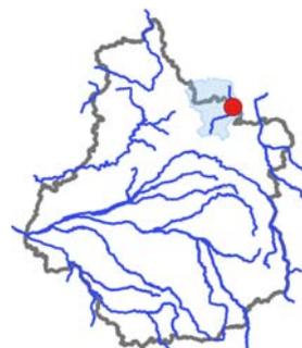
La station de Boulancourt a enregistré un débit journalier maximal de 34 m<sup>3</sup>/s le 2 juin, pour un débit de crue de fréquence cinquantennale estimé à 13 m<sup>3</sup>/s. Les débits instantanés mesurés par jaugeage sur cette station atteignent 36 m<sup>3</sup>/s le 2 juin.
