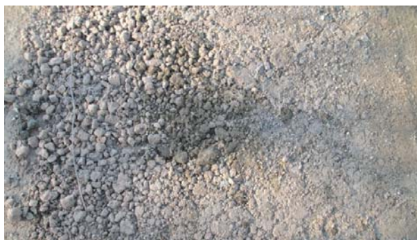
Fig. 2 Widok zniszczonej w wyniku zamarzania przesłony wykonanej w technologii WIPS z zastosowaniem spoiwa na bazie ubocznych produktów spalania.
