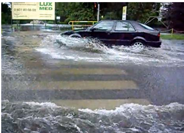
Rys. 8. Woda wybijająca się po opadzie przez studzienki położone na kolektorze prowadzącym strumień Wierzbak. Źródło: archiwum autora
